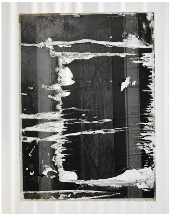
Abb. 2 Glasplattennegativ mit aufgelöster und zerflossener Emulsionsschicht.
