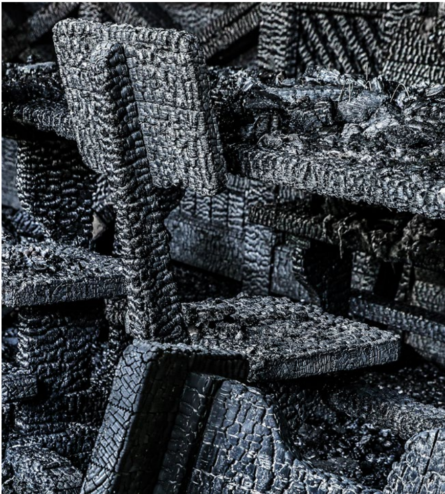
Abb. 4 Stark verkohltes, würfelbrüchiges Holz nach einem Brand
