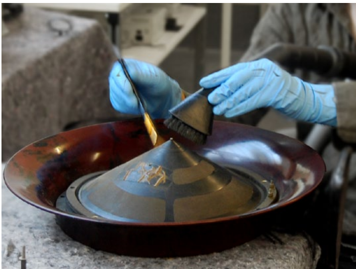
Abb. 15 Reinigung eines Lautsprechers aus Phenol-Formaldehyd mit Pinsel und Staubsauger
